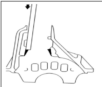
4. 用铜棒拆卸主动锥齿轮后轴承外圈。
